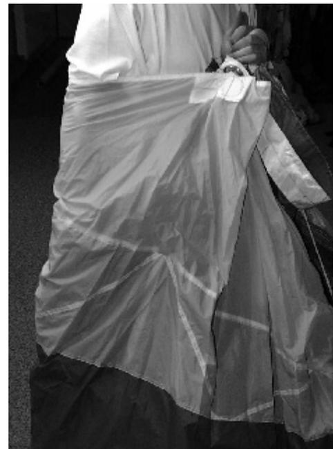
**#12** Verfolgen Sie die D-Leinen einer Seite mit der Hand, ziehen diese leicht heraus und legen Sie diese zur Kappenmitte so ab, daß sich zwischen den C- und D-Leinen gleichfalls ein S-Schlag bildet. Wiederholen Sie den Vorgang auf der anderen Seite.
