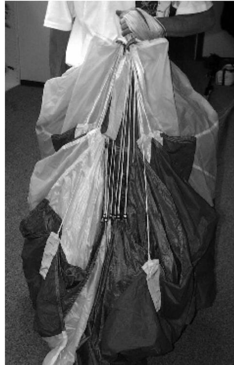
**#13** Ergreifen Sie nun die Steuerleinen einer Seite am Schirmende und ziehen Sie diese mit der Steuerkante aus der Kappe heraus. Legen Sie die Steuerkante in S-Schlägen zur Mitte hin ab. Wiederholen Sie den Vorgang auf der anderen Seite. Legen Sie den Slider sternförmig in der Kappe aus.
