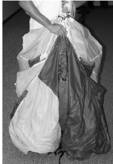
**#15** Ergreifen Sie nun den überschüssigen Stoff einer Hälfte der Steuerkante und ziehen denselben seitlich heraus.
