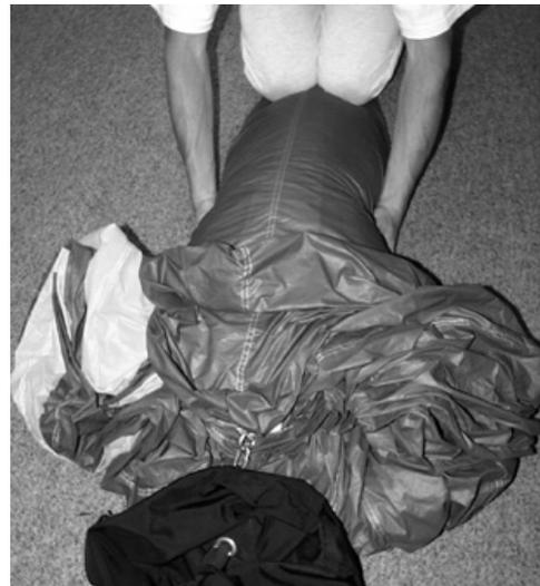
**#21** Achten Sie darauf das die Naht der Mittelzelle weiterhin in der Mitte bleibt. Abschließend legen sie sich kurz auf den Schirm um die Restluft heraus zu drücken.
