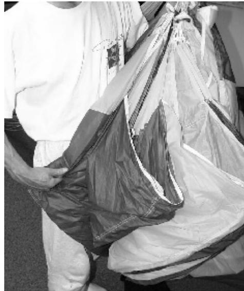
**#17** Stecken Sie die gerollten Zellöffnungen in die Mittelzelle, wobei der rechte Teil in die rechte Halbzelle und der linke Teil in die linke Halbzelle gesteckt wird.
