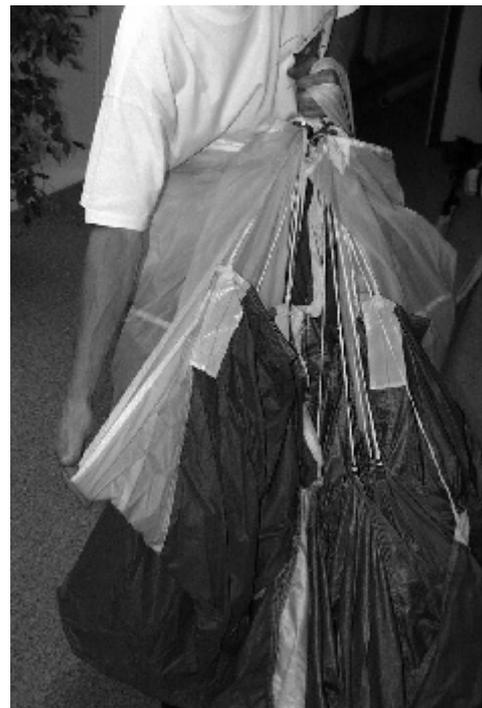
**#14** Greifen Sie nun nach unten und nehmen Sie die Steuerkante der Mittelzelle auf (siehe Markierung am Fallschirm) . Halten Sie die Mittelzelle mit der Hand am Leinenbündel fest.
